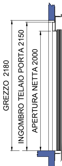
SEZIONE TELAI PORTE NF (EI120)
