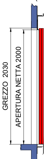
SEZIONE TELAI PORTE NF (EI120)
